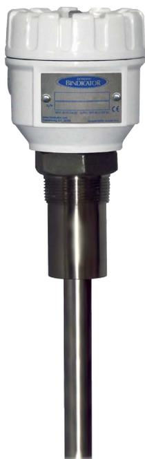
**概述** LP-500ST 是通过一个振动的探杆来感应物料的存在，振荡晶体使探杆在空气中振动，当物料接触到探杆顶端时，由于物料的阻尼作用，探杆的振动幅度减小了，当材料离开后，他返回自由振动，接收晶体会感应到这一差别，并相应地改变输出继电器的状态。
