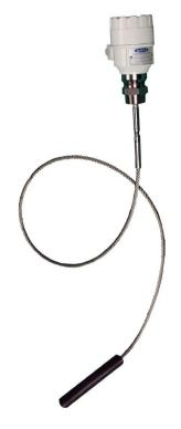
概述 TDR-2000 利用导向微波雷达技术提供连续的非机械物料高度测量。 TDR-2000 特别适用于固体、颗粒、粉末以及多数液体的测量。在许多应用中, 相对于电容、超声波和重锤技术,TDR-2000 是既经济又优越的选择。
