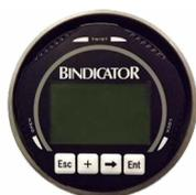
**概述** MP-70采用 26GHz 高频脉冲雷达信号，最大量程 70m。专为固体的连续测量设计，不受温度、压力变化或蒸汽液位改变的影响，可以用于固体（包括但不限于水泥粉末，塑料颗粒/粉末，谷物，面粉，煤，焦炭等）的连续测量，点阵式 LCD 液晶屏显示，瞄准器和吹扫连接可选，支持 HART® 协议和 4-20mA 输出。
